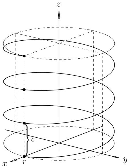
Abb. 9.22 Durch  $f := [0, 6\pi] \rightarrow \mathbb{R}^3$  mit  $f(t) = (r \cos t, r \sin t, ct)$  ist eine Schraubenlinie mit der (positiven) Ganghöhe  $c$  definiert (Rechtsgewinde). Wenn  $t$  das Intervall  $[2i\pi, 2(i+1)\pi]$  durchläuft ( $i = 0, 1, 2, 3, \dots$ ), dann durchläuft  $f(t)$  genau einen Gewindegang. In der Abbildung sind drei Gewindegänge dargestellt. Für  $c < 0$  entsteht eine „absteigende“ Schraubenlinie (Linksgewinde).
