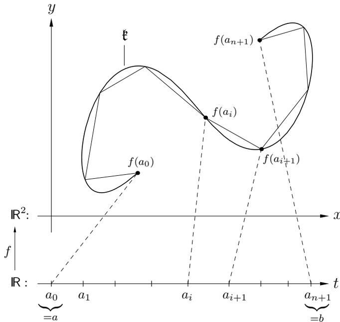
Abb. 9.23 Die Abbildung zeigt eine Kurve im  $\mathbb{R}^2$  mit einem eingeschriebenen Polygonzug. Dabei ist  $f : [a, b] \rightarrow \mathbb{R}^2$  stetig und  $\mathfrak{k} = \{f(t) : a \leq t \leq b\}$ . Ist  $\mathfrak{z} = (a_0, \dots, a_{n+1})$  eine Zerlegung von  $[a, b]$ , dann liegen die Bildpunkte  $f(a_i)$ ,  $i = 0, \dots, n + 1$ , auf der Kurve  $\mathfrak{k}$ .
