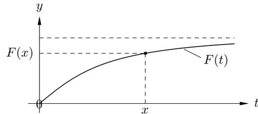
Abb. 9.17 a Der Flächeninhalt der schattierten Fläche ist durch das bestimmte Integral  $F(x) := \int_0^x f(t) dt$  gegeben.
