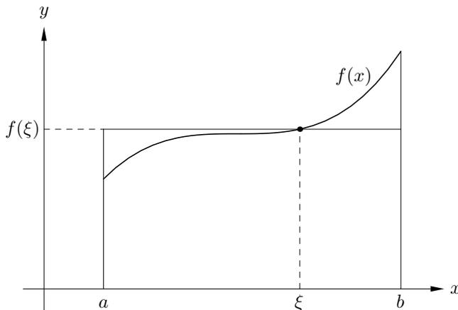
Abb. 9.11 Die Abbildung zeigt einen Spezialfall des Korollars, wobei in dem Teil (2) die Funktion  $g$  in  $I$  konstant 1 gewählt wurde. Die durch das Integral  $\int_a^b f(x) dx$  bestimmte Fläche der Punktmenge  $M = \{(x, y) : x \in I, 0 \leq y \leq f(x)\}$  ist dann flächengleich mit dem Rechteck der Breite  $b - a$  und der Höhe  $f(\xi)$ .
